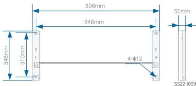
Figura 4-1 Dimensões do suporte de instalação
